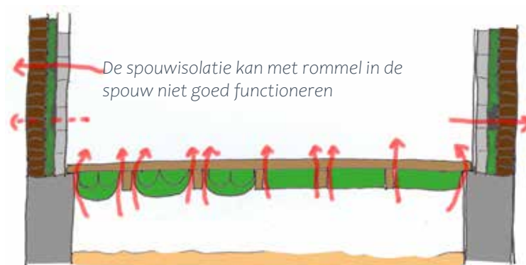
Tussen de aangebrachte isolatiematerialen (groen) en de balken of muur kunnen kieren zitten.
