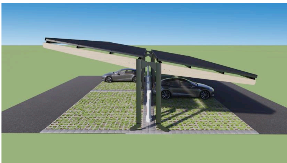
Figuur 2: ontwerp van de carportconstructie
